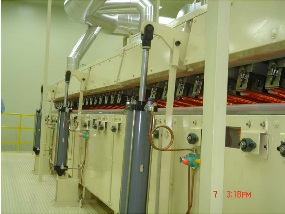
爐長供 9M, 安排紅外線石英加熱燈管 27pcs
